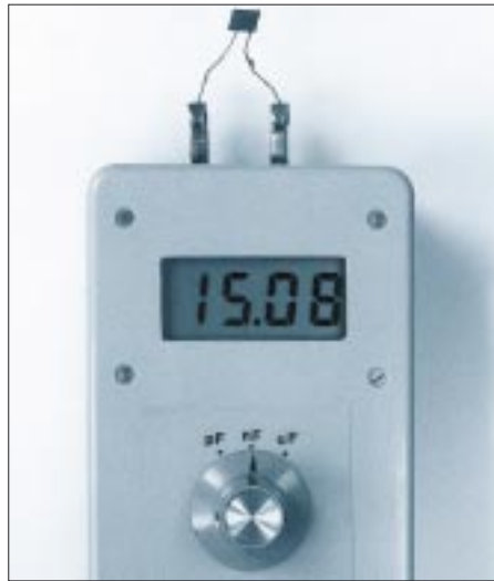
Bild 9: Der Kapazitätswert des zu bestimmenden Kondensators wird bei einer Messung direkt am LC-Display angezeigt.
