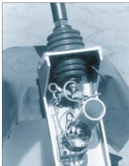
Bild 2: 80-m-Anpaßbox für eine 4,5 m lange Stabantenne. Links oben innerhalb der Halterung die keramischen Rohrkondensatoren (3 Stck., insgesamt 1600 pF, darunter die angezapfte 5- \mu H-Luftspule, rechts davon die 40- \mu H-Spule mit aufgebrannter Wicklung.
