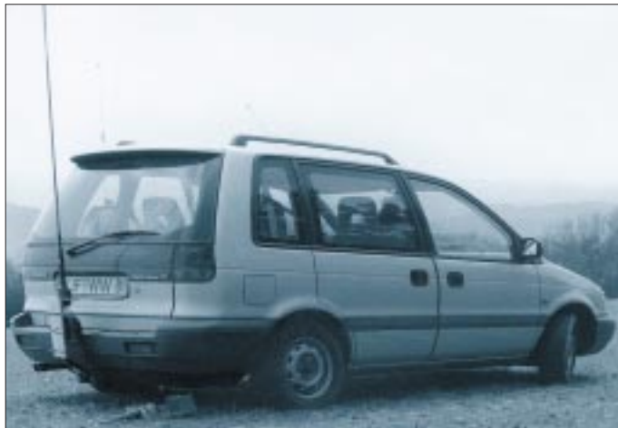
Bild 1: „Stand-Mobil“- oder besser Pkw-Portabeleinsatz auf 80 m mit an der Hängerkupplung befestigter Abstimmbox. Eine mit Scheibenvariometern aufgebaute Zweitbox liegt hinter dem Fahrzeug.
